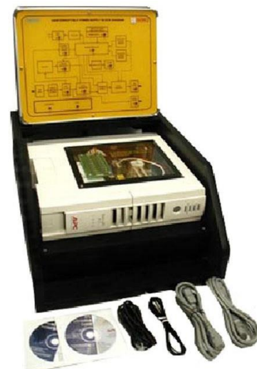
تجهیزات آموزشی مربوط به برق اضطراری (UPS)
